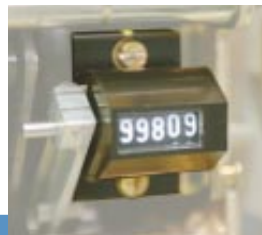
Mechanické počítadlo spínacích cyklů
