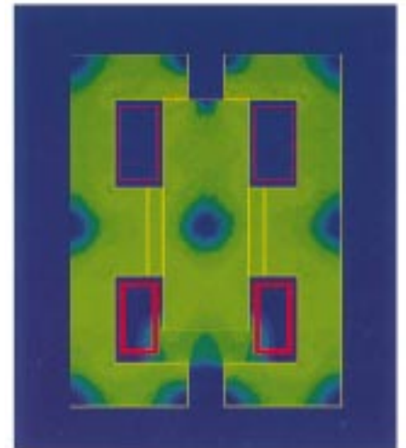
Pulzní proud magnetického blokovacího zařízení vytvořený v jedné cívkce
