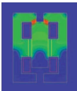
Obr. A – Magnetický obvod v zapnuté poloze.
