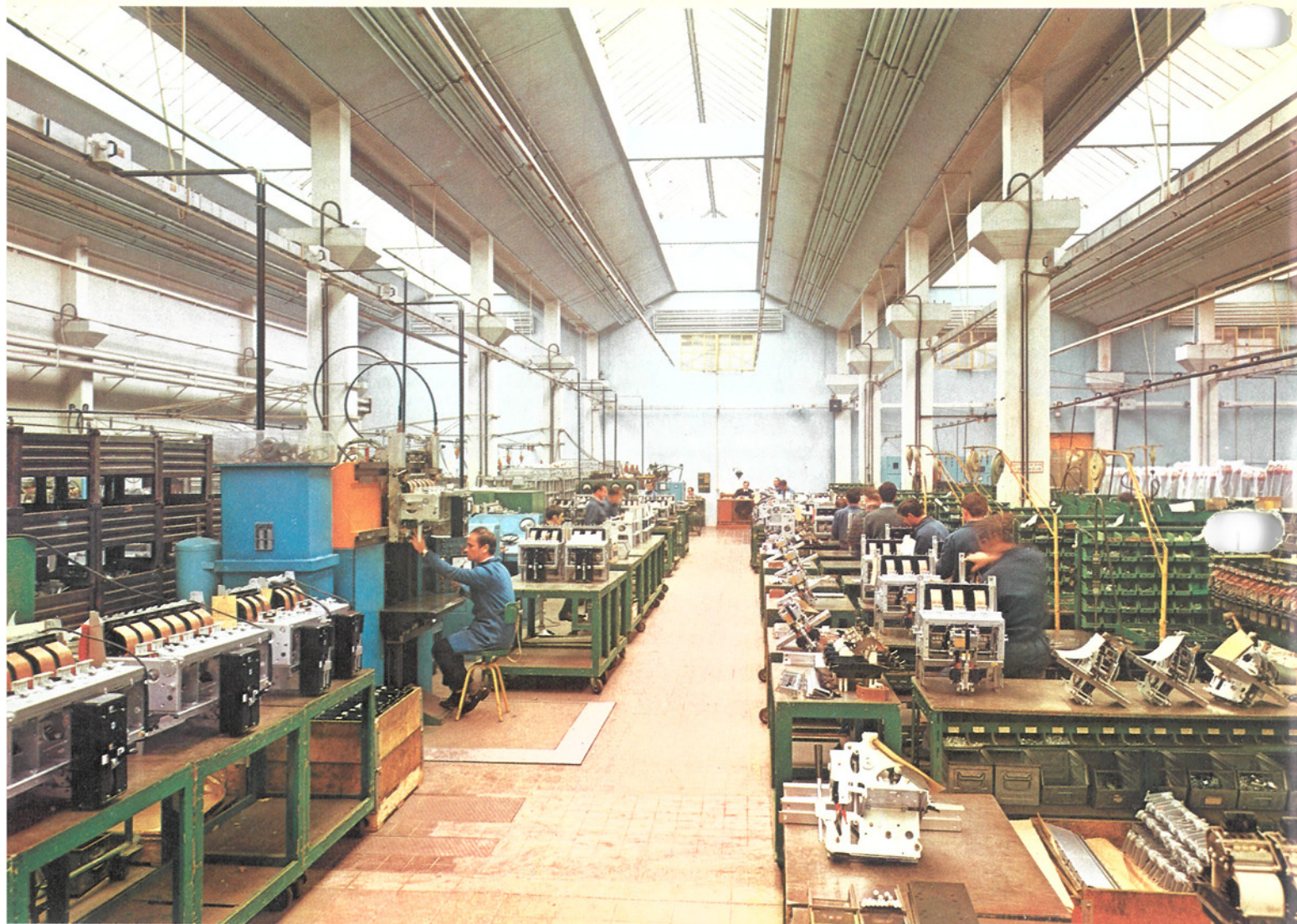
Stabilimento SACE di Bergamo Linea di montaggio degli interruttori OTOMAX
