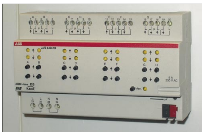
Obr. 1. Osmínásobný žaluziový akční člen s přímým silovým ovládním
