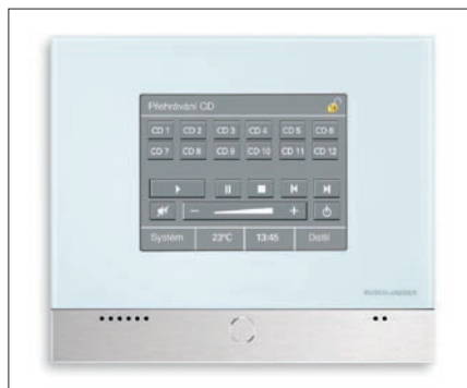
Obr. 1. Strana pro ovládání CD-ROM na dotykovém panelu ABB
